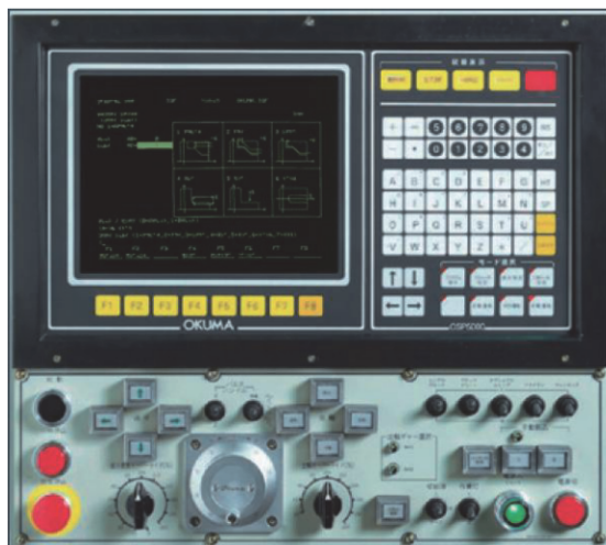
รูปถ่ายที่2 อุปกรณ์NC"OSP5000"ซึ่งติดตั้งฟังก์ชันโปรแกรมมิ่งเชิงสนทนา"IGF"
