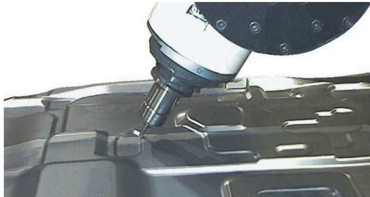
รูปถ่ายที่4 สภาพการขึ้นรูปที่ใช้ฟังก์ชันควบคุมการขึ้นรูปคอนทัวร์ความเร็วสูง"Super-NURBS"
